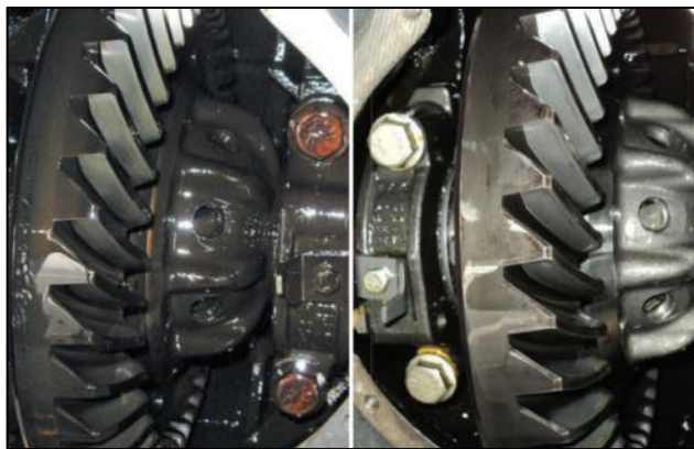
Fig. 7. Aspecto da formação de verniz por oxidação do óleo numa caixa diferencial.
